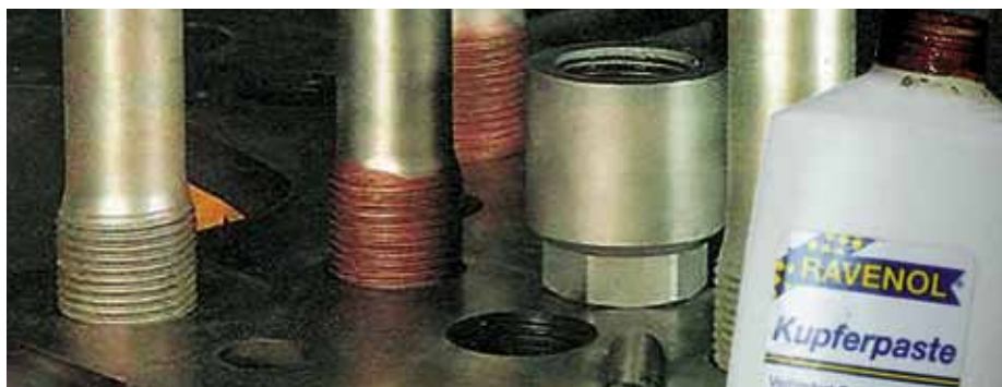
▶ Болты обшивки турбин на электростанции
